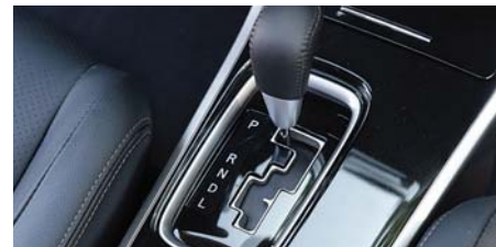
Šesťstupňový automat je v Outlanderi k dispozícii len s dieselovým motorom 2.2 DI-D
