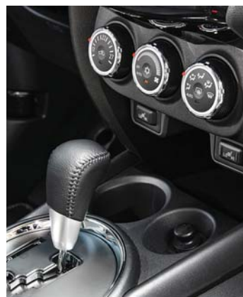
Volič automatickej prevodovky má hlavicu obšitú kožou. Prepínanie pohonu všetkých kolies je pomocou tlačidla vedľa páky klasickej ručnej brzdy
