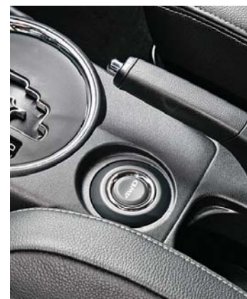
Volič automatickej prevodovky má hlavicu obšitú kožou. Prepínanie pohonu všetkých kolies je pomocou tlačidla vedľa páky klasickej ručnej brzdy
