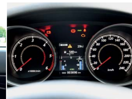
Prehľadné ukazovatele a farebný displej, na ktorom sa zobrazuje aj indikátor preradenia
