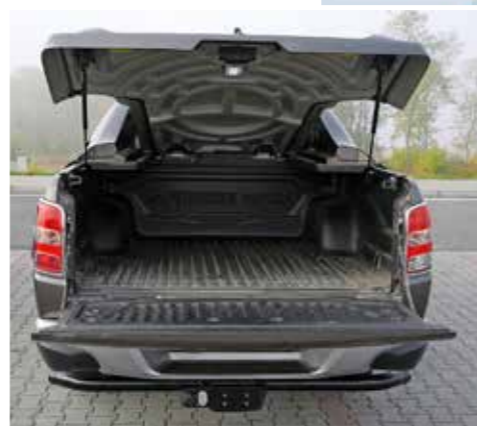
Nákladný priestor s príplatkovým krytom Full Box má plynové vzpery, vnútorné LED osvetlenie a, samozrejme, je uzamykateľný.
