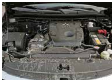
Motor 2.4 DI-D MIVEC má výkon 181 koní a extra nízky kompresný pomer, ktorý mu pomáha v lepšej kultúre chodu aj životnosti.
