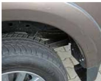
Listové pružiny vzadu boli predĺžené. Korba znesie zaťaženie hmotnosťou 960 kilogramov.
