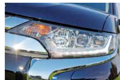
Súčasťou predného „dynamického štítu“ sú aj výrazné pochrómované prvky a tiež LED svetlomety.
